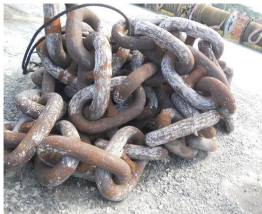
Figura 18: Típico conjunto de peso morto (BELOV, 2018)
