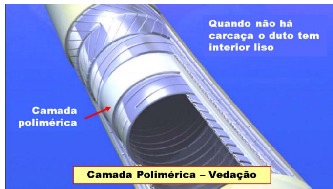
Figura 4: Camada Polimérica. Modificado de (Flexi France, 2006)
