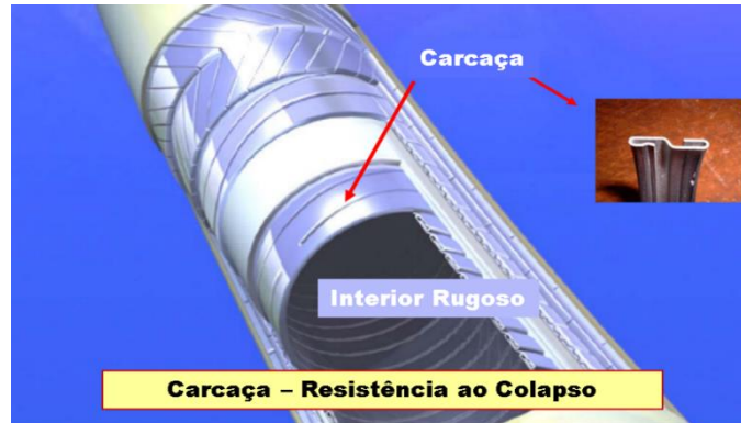
Figura 3: Carcaça. Modificado de (Flexi France, 2006)
